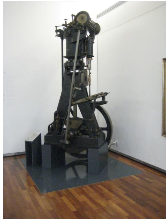
Rudolf Diesel bygget og utviklet denne eksperimentmotoren fra 1893 til 1895. motoren står nå på MAN-museet i Augsburg. (Eget foto)
